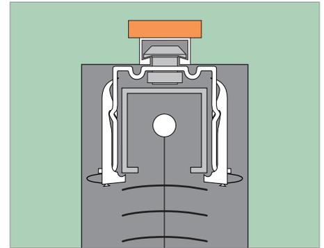
Die vormontierte Halfenschiene gewährleistet eine extrem schnelle und einfache Montage. Einfach einhängen, fixieren und fertig ist der Raffstorebehang im Aufsatzkasten montiert.
