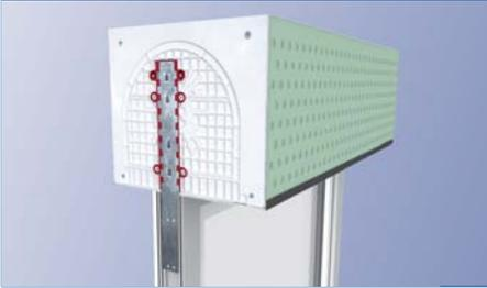
Das Befestigungs-System von Beck+Heun spart Platz beim Transport und vereinfacht das Aufsetzen des Rollladenkastens auf Ihr Fenster. Durch einfaches Nachjustieren und ohne Zusatzprofile ist das Komplettlement in wenigen Arbeitsschritten fix und fertig montiert. Dazu einfach mitgelieferten Befestigungsstiel in vormontierten Montageschuh bei Fertigmontage einschieben.
