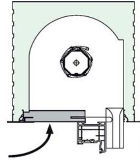
Mit dem ROKA-TOP-RO setzen Sie auf einen jahrelang bewährten Aufsatzkasten in Sachen Schallschutz und Wärmedämmung.
