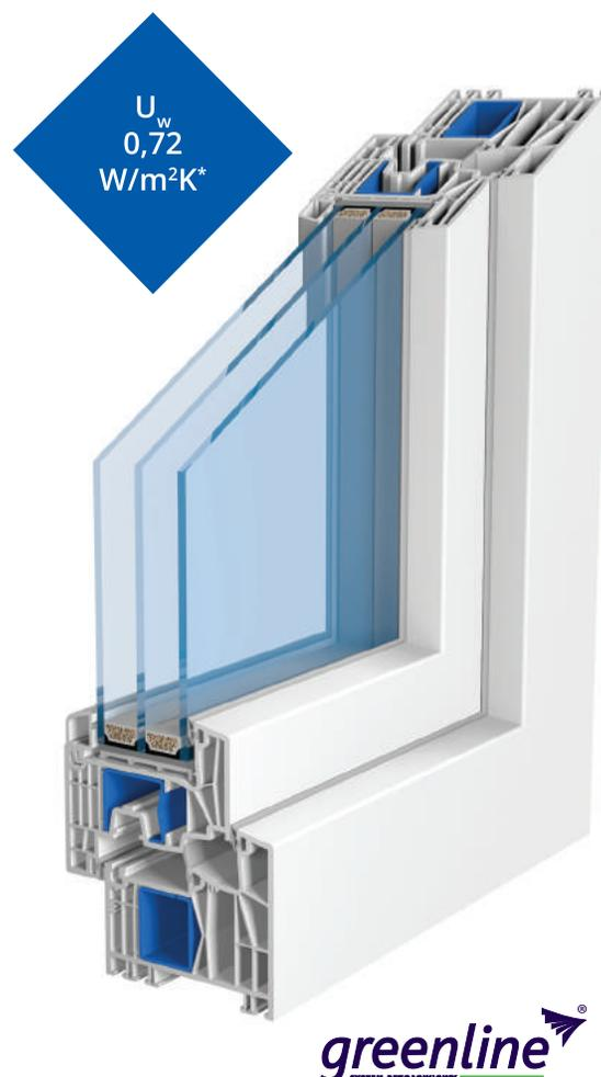
(\*) Der  $U_w$  Parameterwert beträgt  $0,72 \text{ W/(m}^2\text{K)}$ \* für Referenzfenster mit den Abmessungen  $1230 \times 1480 \text{ mm}$ . Für die Berechnungen wurde angenommen: a) dreifacher Glasscheiben-Set mit einer Dicke von 48 mm, b) Wärmedurchgangskoeffizient der Glasscheibe von  $U_g = 0,5 \text{ W/(m}^2\text{K)}$ , c) linearer Wärmedurchgangskoeffizient des Zwischenscheibenrahmens  $\psi_i=0,03 \text{ W/(m}^2\text{K)}$ , d) Stahlverstärkung V 310 (Rahmen) und V 308 (Flügel).
