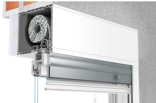
Der TP1000K-Rollladen ist an der Innenseite eingebaut. Das innere Stirnprofil ist geriffelt und mit einer Putzleiste ausgestattet. Das äußere Stirnprofil ist glatt, was bessere Optik garantiert. Die Revisionsklappe wird bei diesem Einbau von unten eingesetzt und Bedienung des Rollladens erfolgt vom Inneren des Raums.
