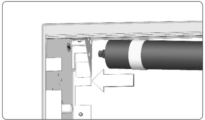
9. Das Ende der Feder in die Öffnung des vorher an die Blendkappe vernieteten Insektenschutzhalters einstecken.
