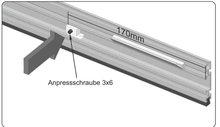
5. Die Riegelsperre in den mittleren Kanal der Insektenschutz-Endschiene einschieben, dabei einen Abstand von 170 mm von ihrem Ende halten, dann die Anpressschraube festziehen, um sie zu verriegeln.
