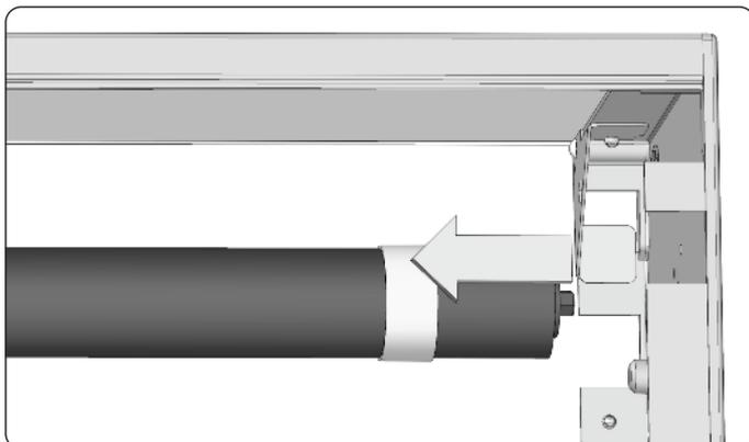
11. Nachdem die Insektenschutz-Feder aufgezogen worden ist, den aus dem Bremshalter herausragenden Schaft drücken, festhalten, an die Öffnung im Blechhalter positionieren und loslassen.
