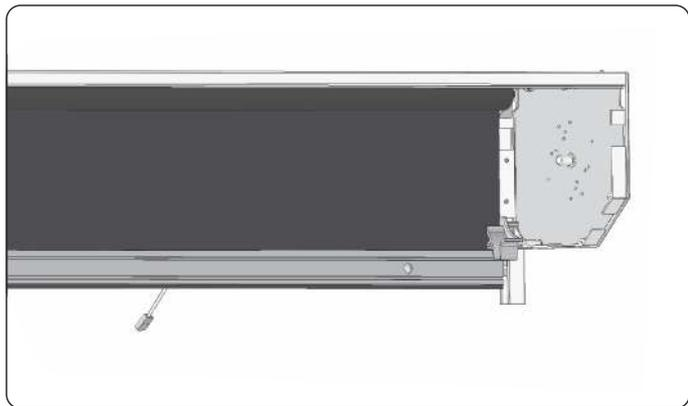
15. Die Insektenschutz-Endschiene mit dem Gitter in die Einlaufrichter einstecken, um die Aufwicklung des Gitters zu verhindern.
